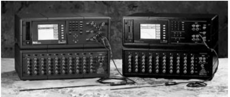
2575 (Mighty-Mux) を使用して 1575A に 10 チャンネル追加できます。10 チャンネル 2590 (Mighty-Mux II) マルチプレクサーを使用して 1590 に最大 50 チャンネルまで追加できます。
